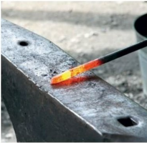
Doc. 6. La partie jaune de cette barre de fer est plus chaude que les parties rouges.
